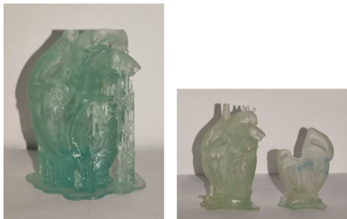
Figura 53. Fotografies del model imprès amb resina al centre, al 25% de la mida original (esquerra) i al 15% (dreta). (Imatges d'elaboració pròpia)
