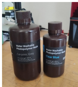
Figura 95. Fotografia de la resina utilitzada durant les proves d'impressió. (Imatge d'elaboració pròpia)
